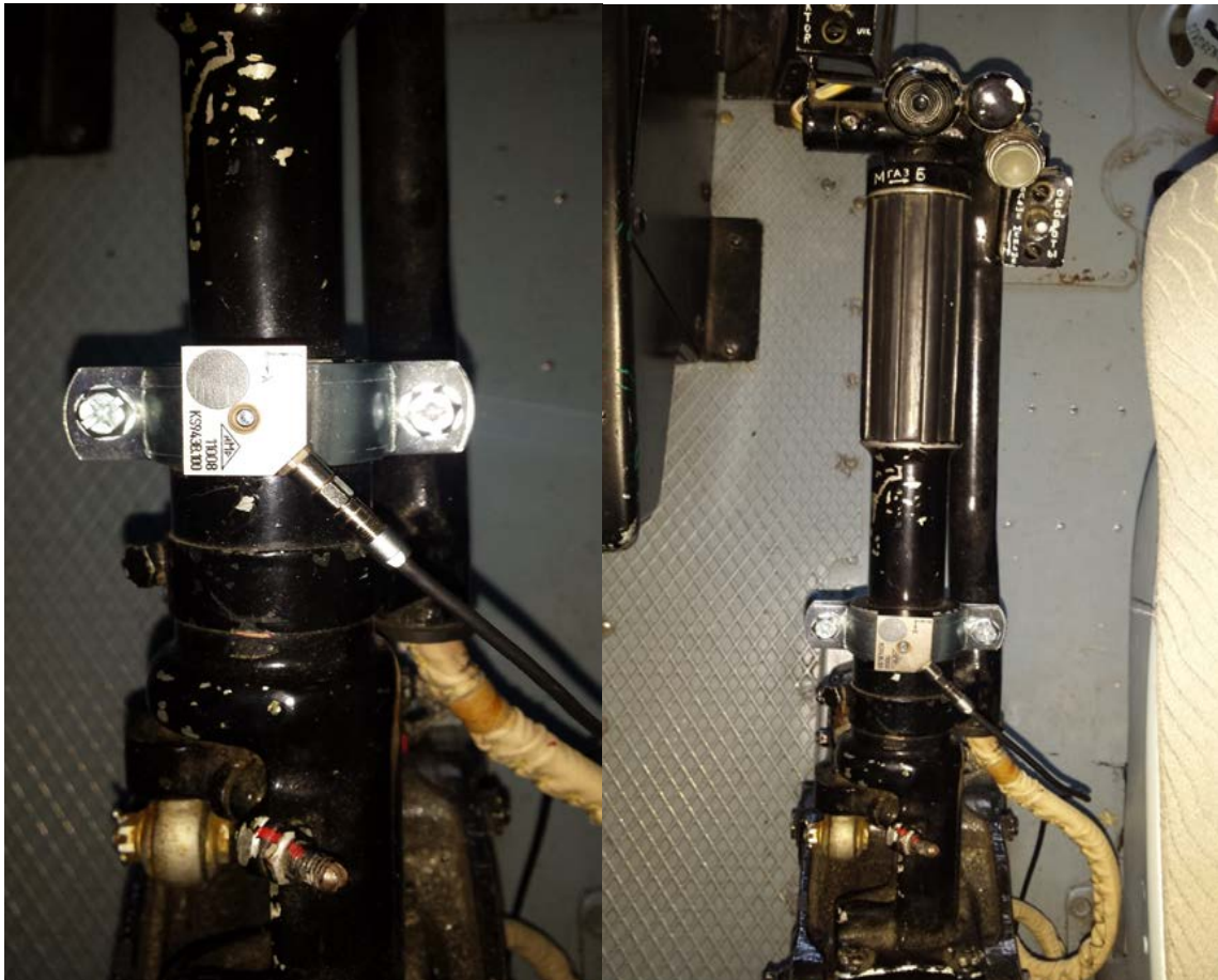
Slika 50. Troosni akcelerometar postavljen na kolektivnoj palici
