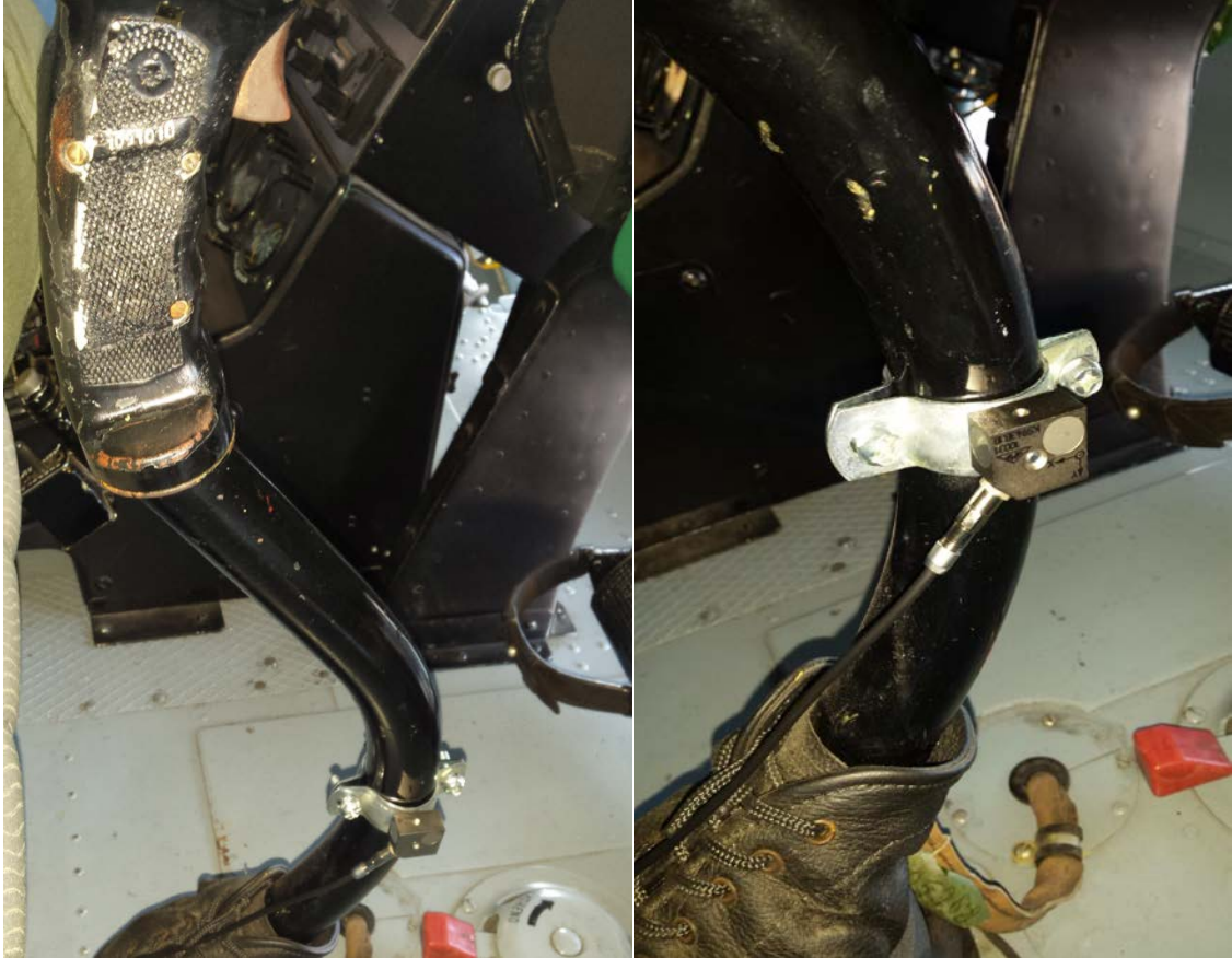
Slika 49. Troosni akcelerometar postavljeni na cikličnoj palici
