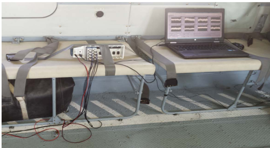
Slika 53. Mjerne kartice za uzorkovanje signala: NI-9234 i NI-9233 u kućištu: Ni-cDAQ-9172
