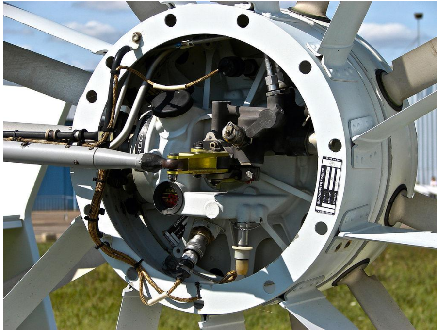
Slika 3. Mehanički sklop fenestrona [7]
