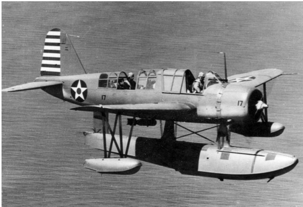
Slika 3. Hidrozrakoplov sa centralnim plovkom [5]
