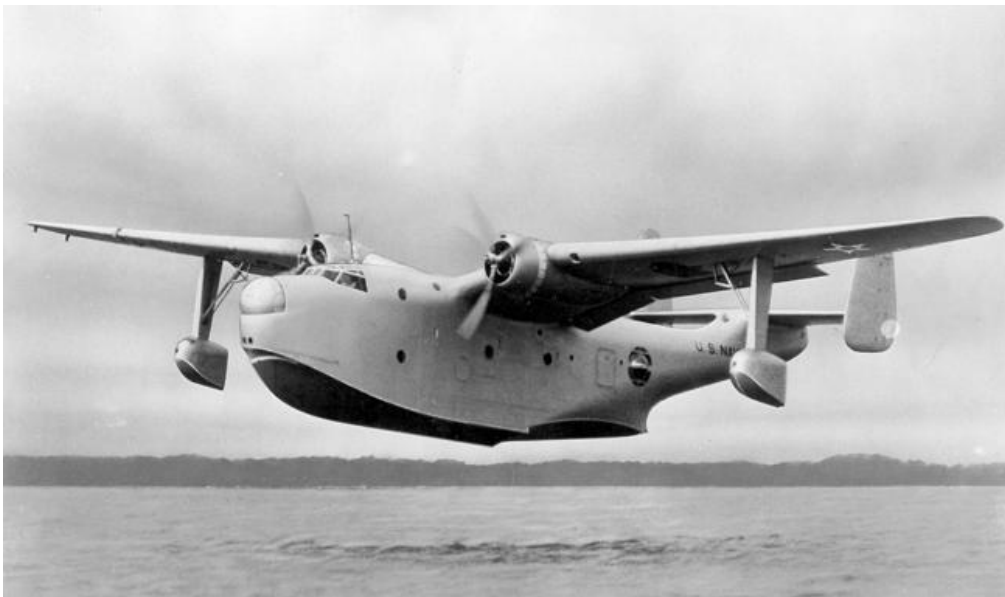
Slika 4. Hidrozrakoplov sa trupom kao centralnim plovkom [6]
