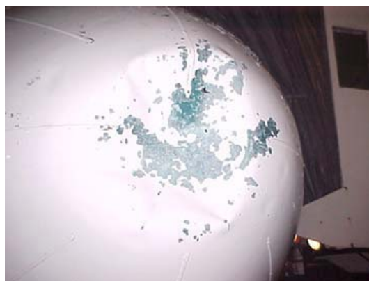
Slika 8. Šteta na zrakoplovu zbog tuče
