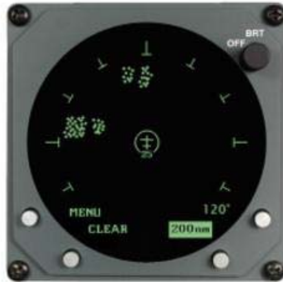
Slika 20. Prikaznik detektora elektrostatickog pražnjenja Stormscope
