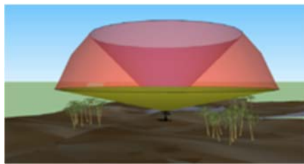
Slika 5. Volumen zraka pokriven radarom 4
