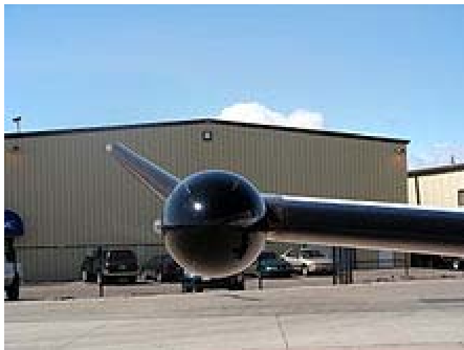
Slika 7. Meteorološki radar na krilu Pilatusa PC-12
