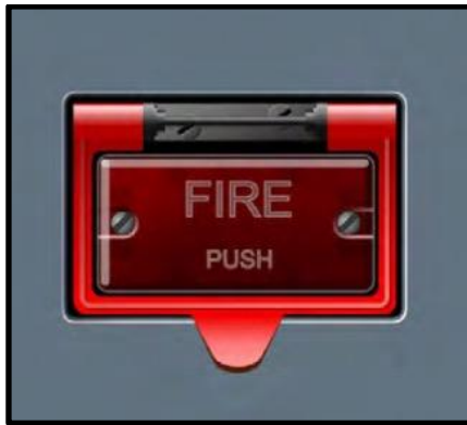
Slika 6. Prikaz FIRE komande u normalnom položaju [1]
