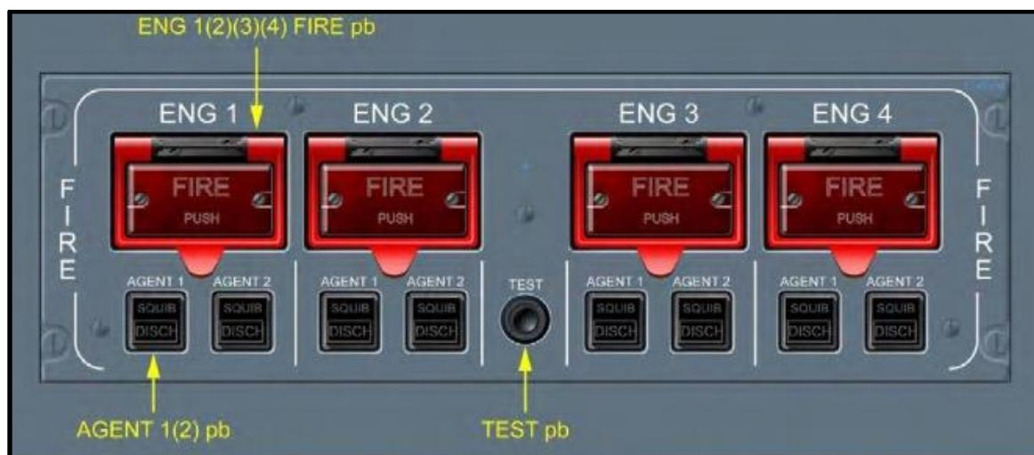
Slika 5. Prikaz FIRE ploče u pilotskoj kabini [1]
