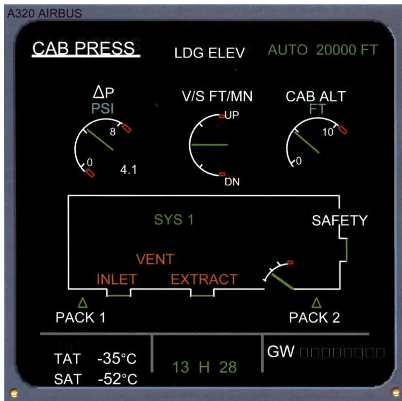
Slika 4.6. Prikaz sustava nadtlučivanja kabine zrakoplova na ECAM-u
