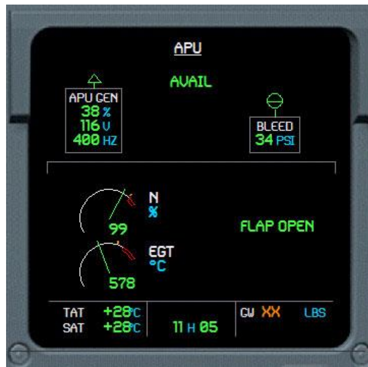
Slika 4.5. Prikaz APU parametara na ECAM-u
