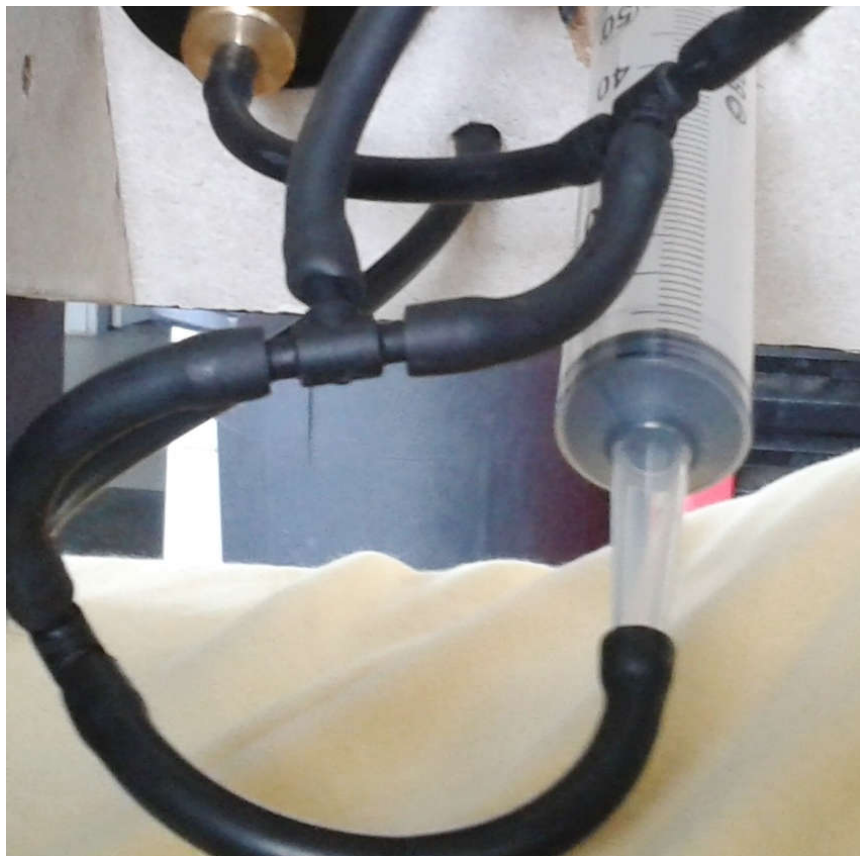
Slika 26. Vakuumska crijeva povezana sa T spojnicom
