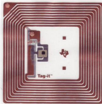
Slika 2.5. Prikaz RFID transpondera [18]
