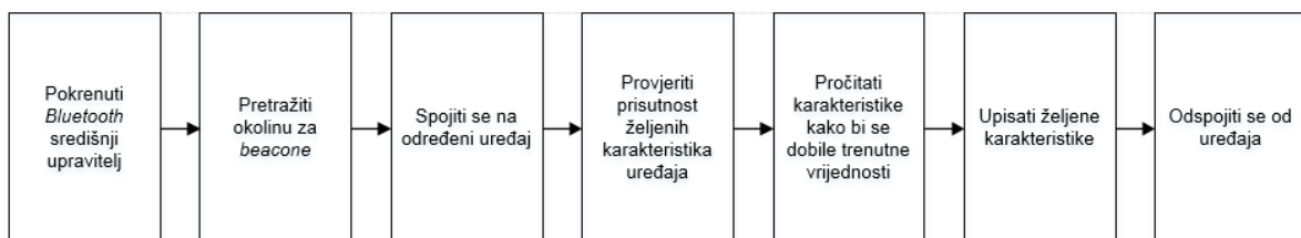
Slika 3.2. Prikaz redoslijeda zapisa informacija na Bluetooth odašiljač [30]
