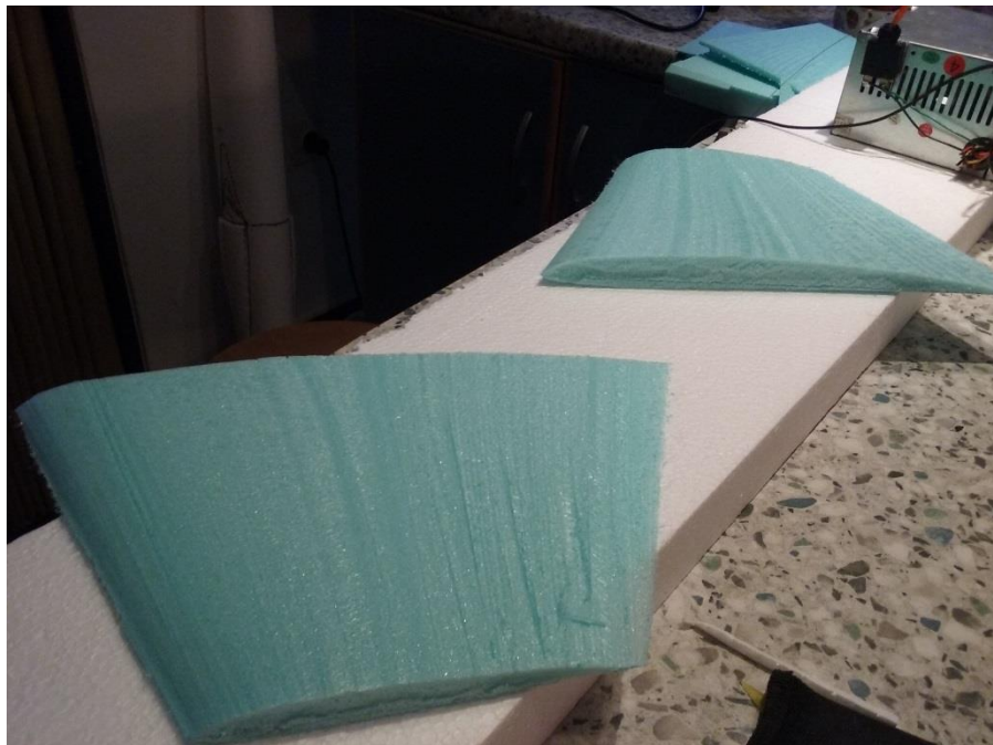
Slika 16. Izvučeni dijelovi trapeznoga dijela krila iz stiroduralne ploče
