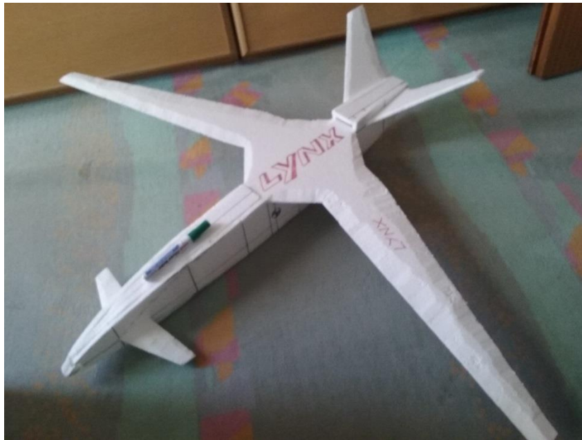
Slika 14. Slobodno leteći umanjeni model za ispitivanje pozicije težišta
