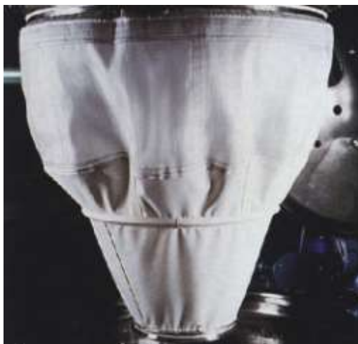
Slika 10. Filtar vreća centrifuge [9]
