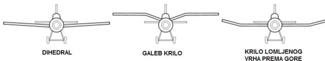
Slika 8. Vrste krila prema kutu pregiba [6]
