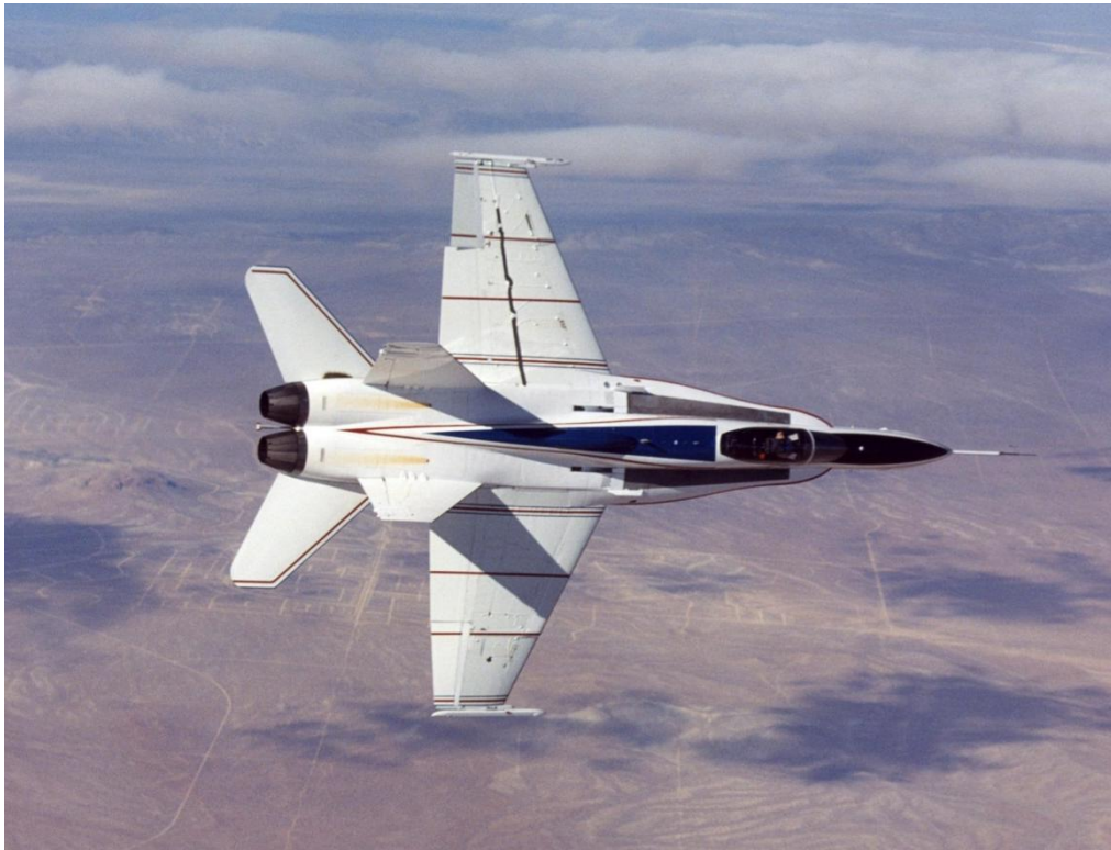
Slika 21. Zrakoplov F-18 s AAW tehnologijom [27]
