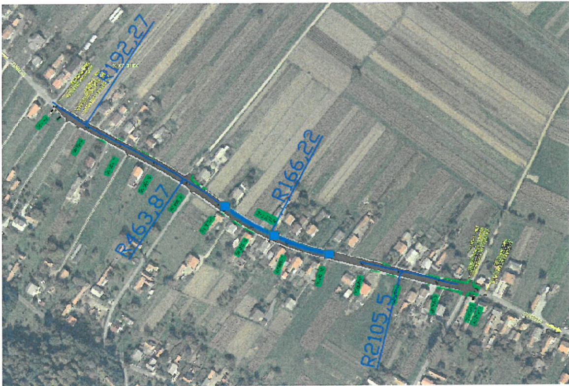
Slika 7. Radijusi horizontalnih zavoja
