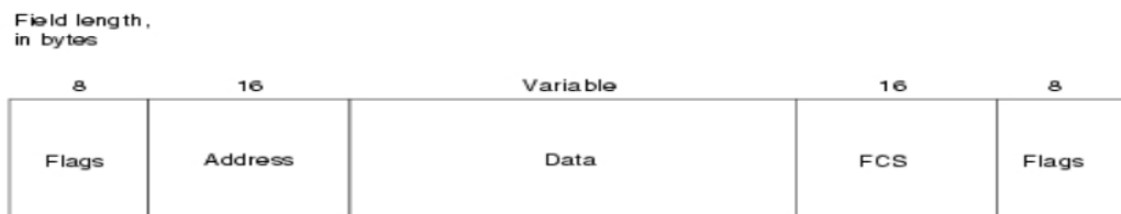
Slika 23. Format frame relay okvira 15
