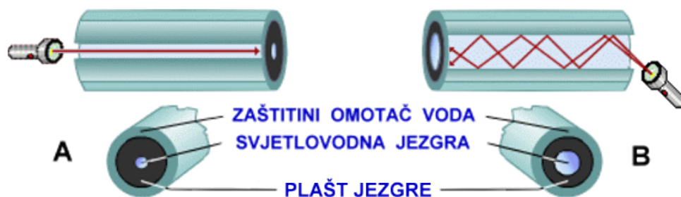
Slika 4. Prikaz prijenosa svjetlosnih zraka i strukture svjetlovodnog kabela (A- jednomodni, B- višemodni)
