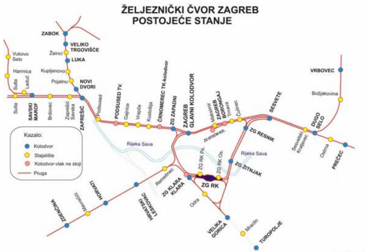
Slika 1. Postojeće stanje željezničkog čvora Zagreb
