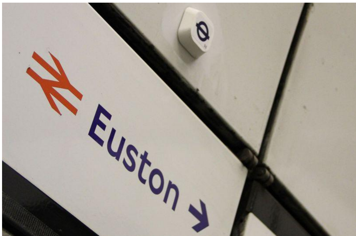
Slika 15. Beacon odašiljač u podzemnoj željeznici
