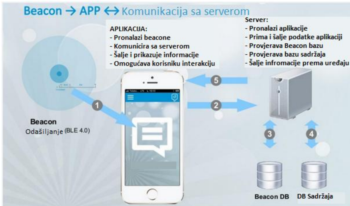
Slika 5. Ciklus slanja i primanja informacija beacon odašiljača
