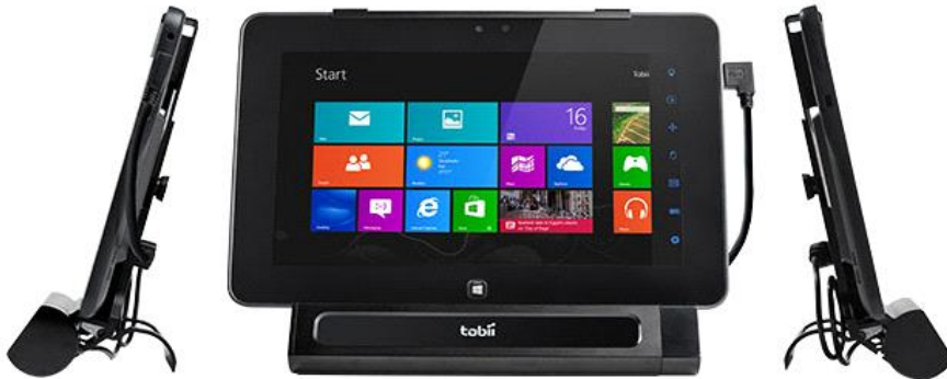
Slika 7. Toby EyeMobile uređaj, [6]
