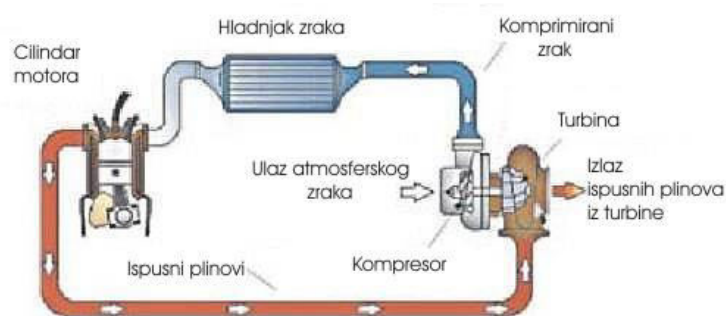
Slika 16: Prikaz sustava hlađenja zraka kod izlaska iz turbopunjača
