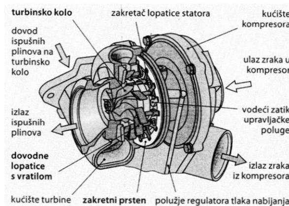
**Slika 22:** Regulacija tlaka nabijanja promjenjivom geometrijom turbine
