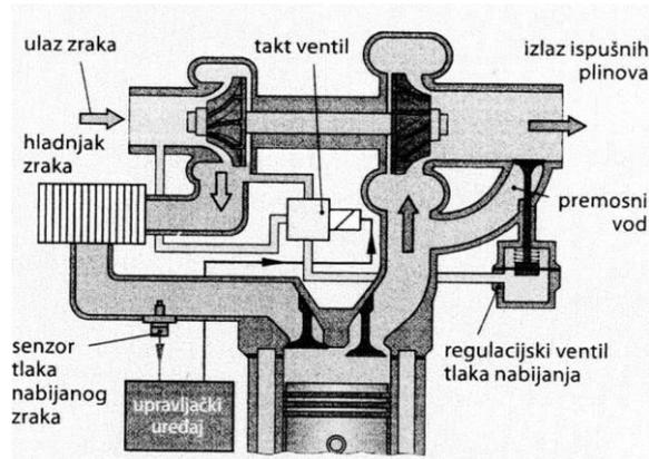
**Slika 20:** Električna regulacija tlaka nabijanja, tlak prenizak
