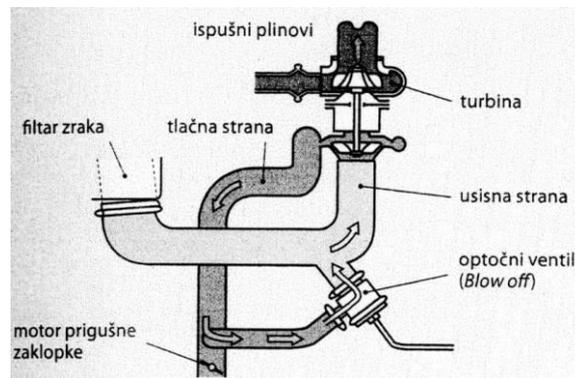
**Slika 19:** Optočni ventil (engl. Blow off valve)
