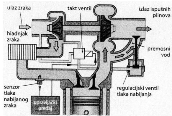
**Slika 21:** Električna regulacija tlaka nabijanja, tlak previsok
