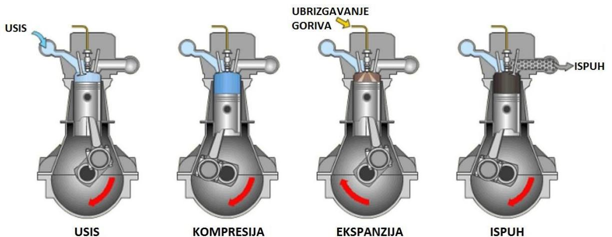
Slika 8: Četiri takta radnog ciklusa Diesellovog motora
