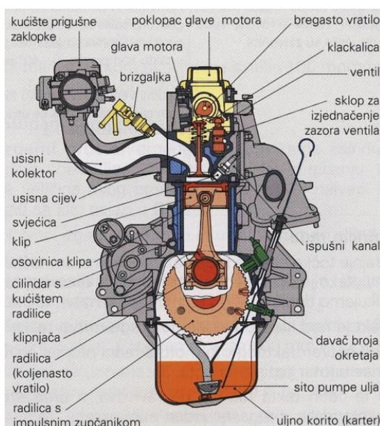
**Slika 1:** Dijelovi motora
