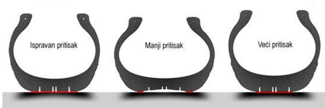
Slika 16. Nepravilno trošenje pneumatika, [14]
