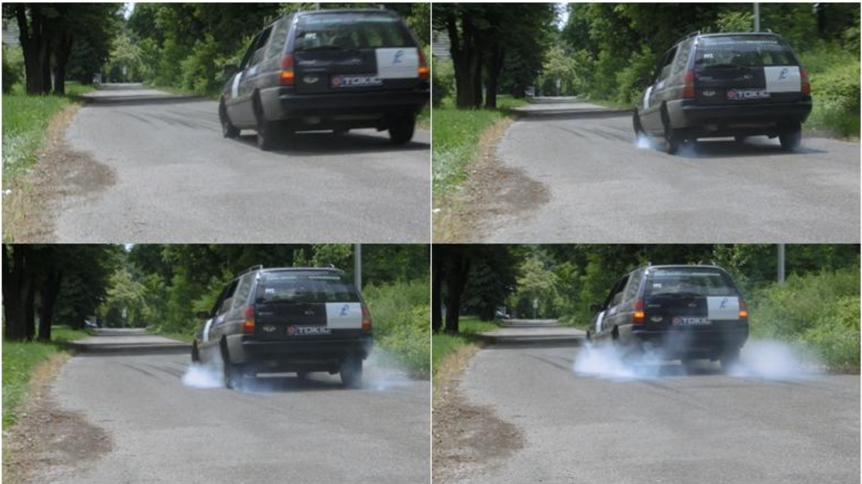
Slika 21. Prikaz nastanka dima prilikom intenzivnog kočenja sa brzinom 50km/h s isključenim ABS sustavom.
