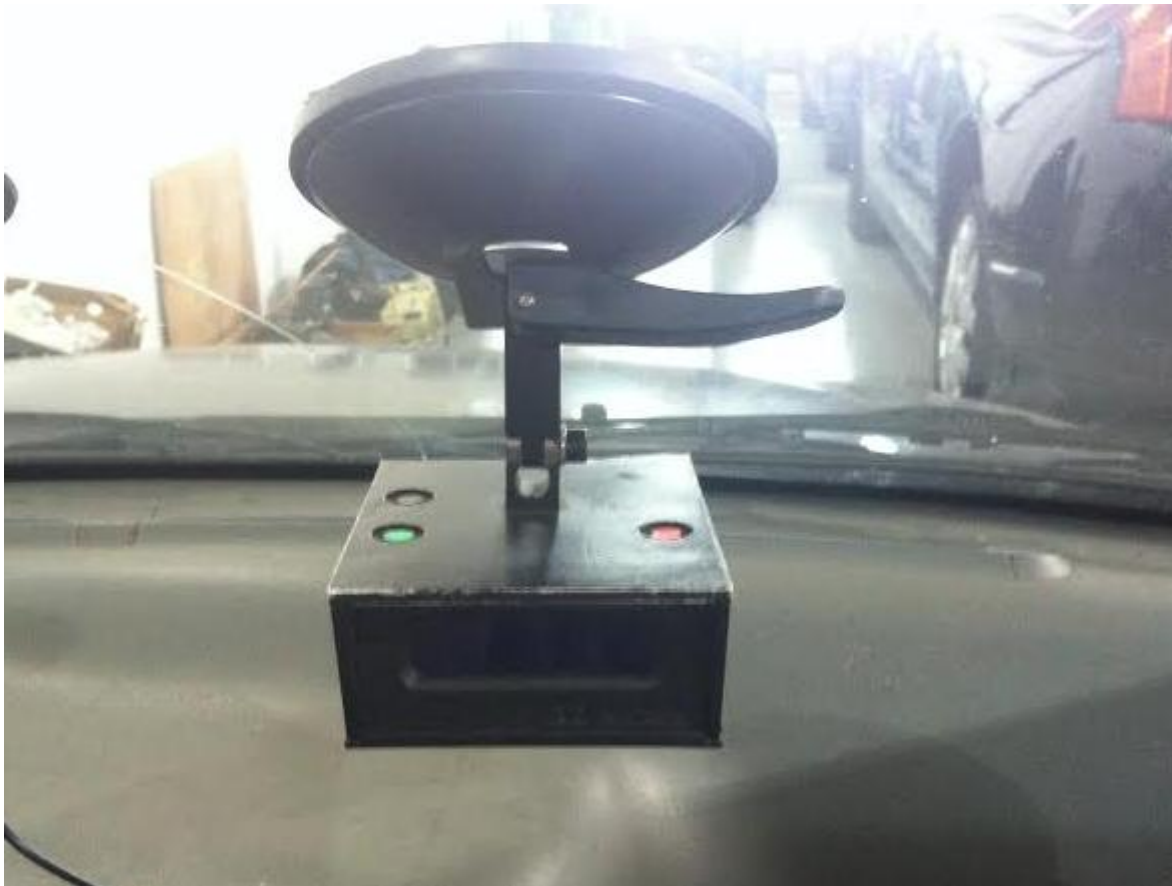
Slika 20. Prikaz postavljenog XL-metra na vjetrobransko staklo vozila, [19]
