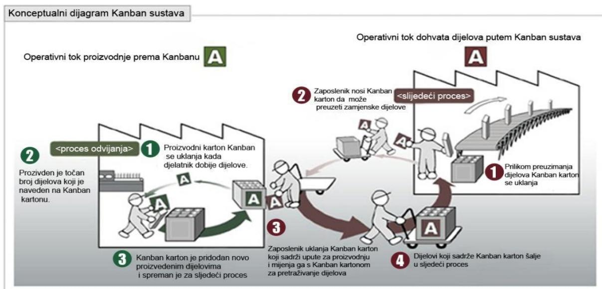
Slika 12. Konceptualni dijagram Kanban sustava
