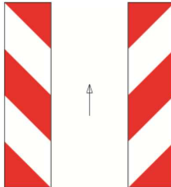
Slika 6.3.8. Ploče za označavanje bočne zapreke (K15 i K16), [12]
