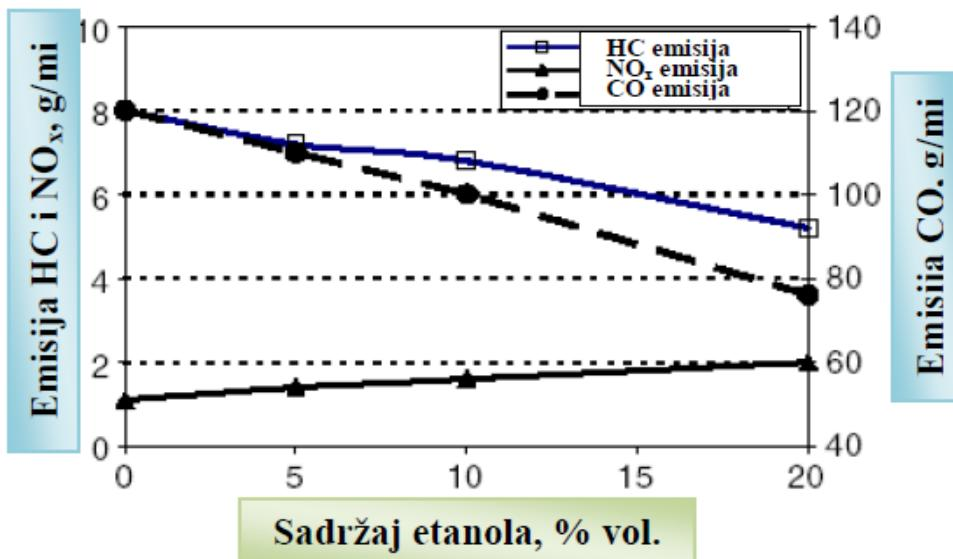
**Slika 11.** Promjene u emisiji HC, NO<sub>x</sub> i CO pri sagorijevanju smjesa motornog benzina i različitog udjela bioetanola, [11]
