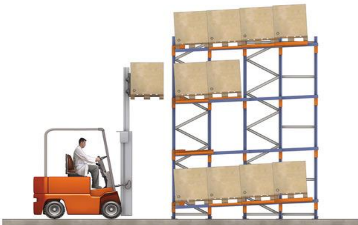
Slika 9. „Push back“ sistem skladištenja paleta
