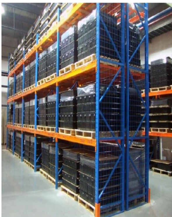
Slika 7. Jednostruki regali za palete Izvor: http://www.jracking.com/product_6_Selective_pallet_racking_system.html , srpanj 2015.
