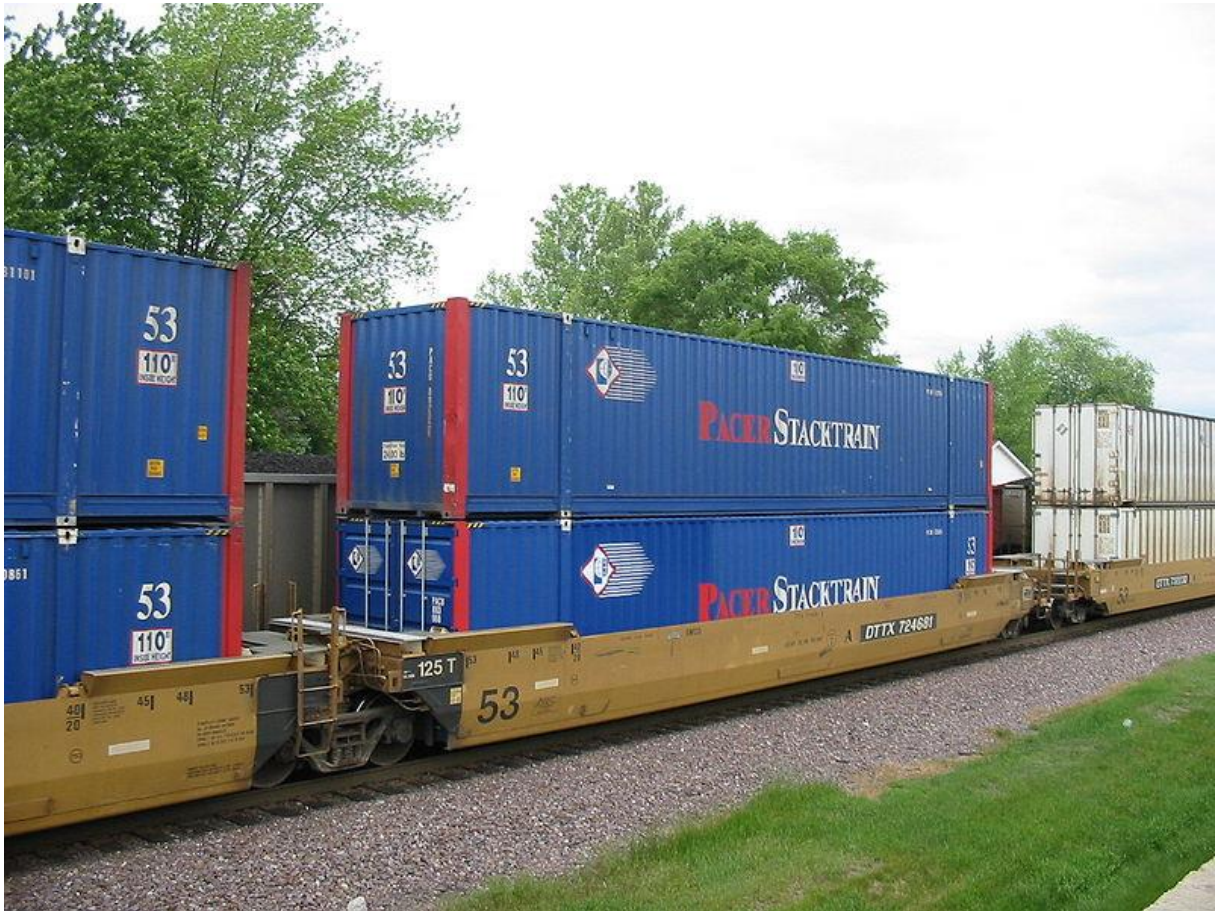
Slika 11. Double stack vagon sa postavljena dva 53 stopna kontejnera
