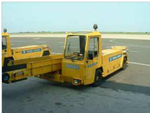
Slika 2. 8.: Elevatorska traka u Međunarodnoj zračnoj luci Zagreb, model Mulag MDF 7.5 Izvor: [1]
