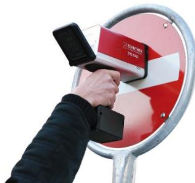
Slika 22. Princip ispitivanja retrorefleksije prometnih znakova ZRS 6060. retroreflektorom
