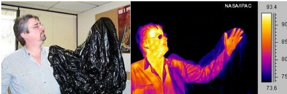
Slika 6. Usporedba standardne i termalne fotografije
