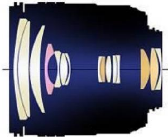
Slika 13. Primjer rasporeda leća unutar objektiva [14]
