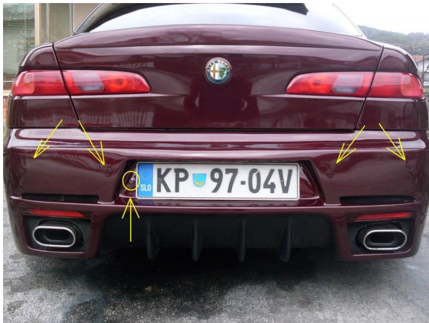
Slika 28. Smještaj senzora za pomoć pri parkiranju unatrag [37]
