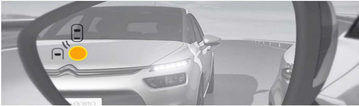
Slika 47. Nadzor mrtvog kuta [45]
