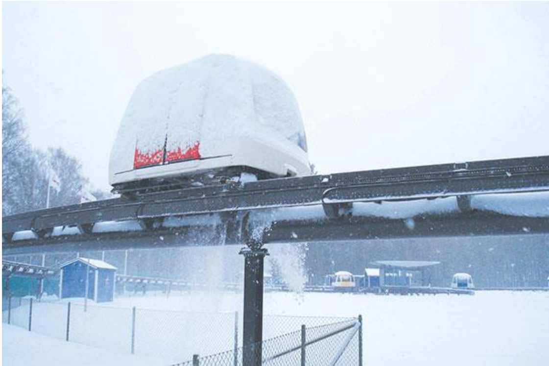
Slika 19. PRT vozilo u teškim vremenskim uvjetima (Suncheon)
