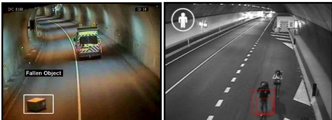
Slika 31. Video detekcija rasutog tereta i pješaka, izvor [30]
