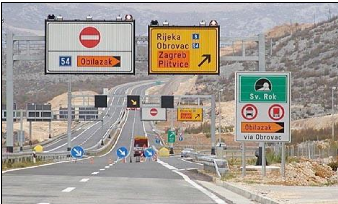
Slika 36. Kontinuirani promjenljivi prometni znakovi (prizmatski), izvor [13]
