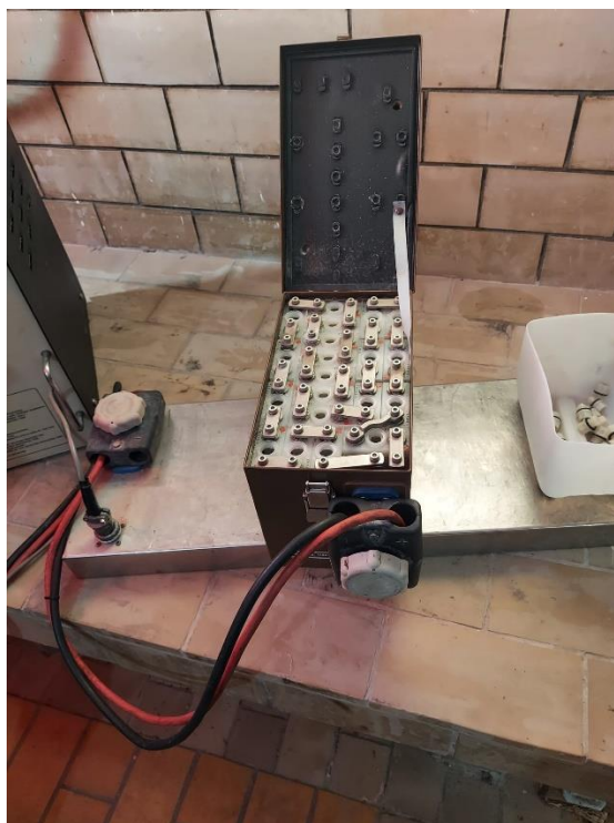
Slika 12. Prikaz ćelija bez pripadajućih čepova
