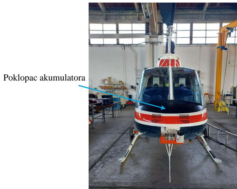
Slika 4. Prikaz položaja akumulatora na helikopteru Bell 206
