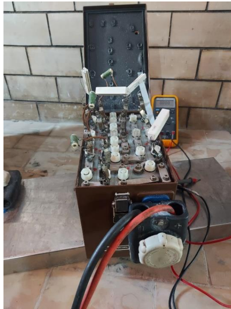
Slika 17. Potpuno pražnjenje akumulatora pomoću otpornika
