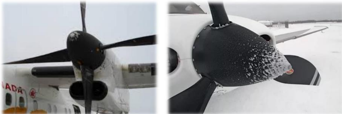
Slika 5. Zaleđivanje propelera zrakoplova Izvor: [10]
