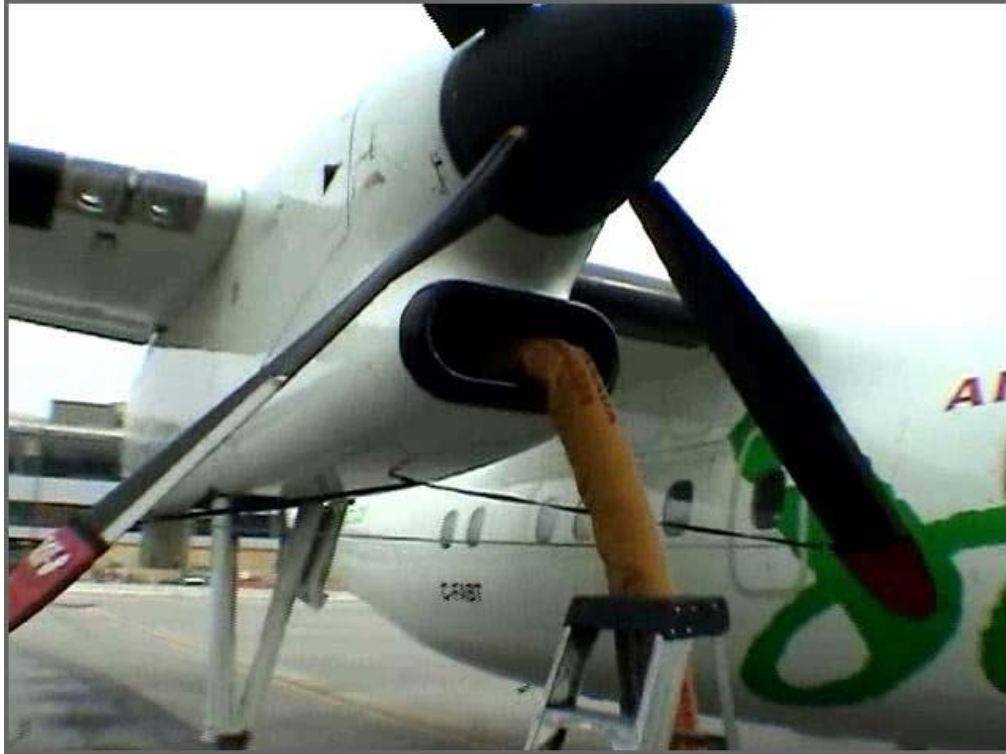
Slika 18. Odleđivanje zrakoplova primjenom vrućeg zraka Izvor: [20]
