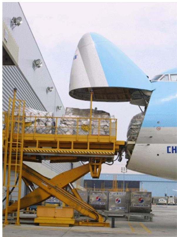
Slika 19. Ukrcaj robe u zrakoplov preko nosnih vrata, [16]
