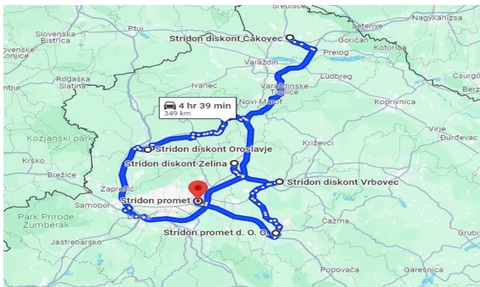
Slika 6. Prikaz kompletne rute vozila ponedjeljkom dobiveno projektiranjem ruta koristeći metodu najbližeg susjeda
