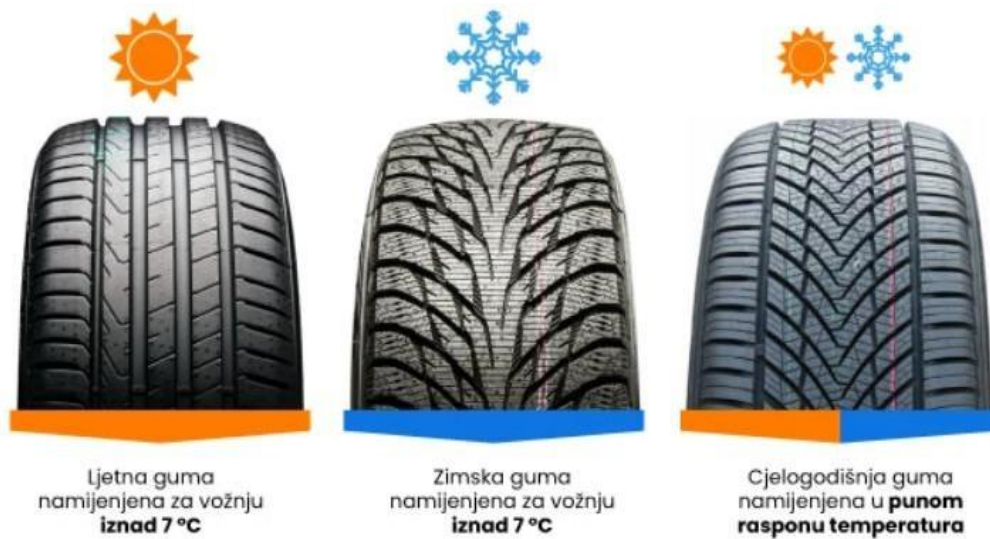
Slika 25. Prikaz usporedbe gazne površine ljetnog, zimskog i cjelogodišnjeg pneumatika Izvor: [22]
