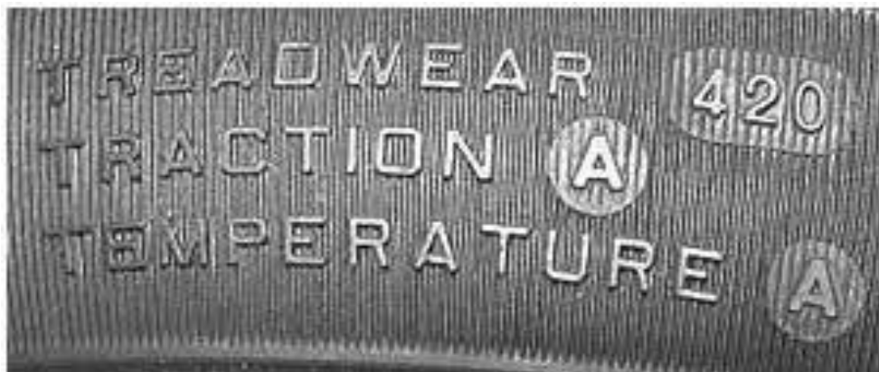
Slika 23. Prikaz Treadwear, traction i temperature oznaka na pneumatiku
