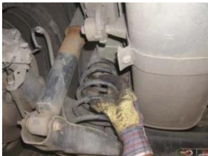
Slika 72. Pregled opruge na tehničkom pregledu vozila
