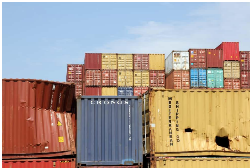
Slika 3 Oštećenje kontejnera pri manipulaciji [6]
