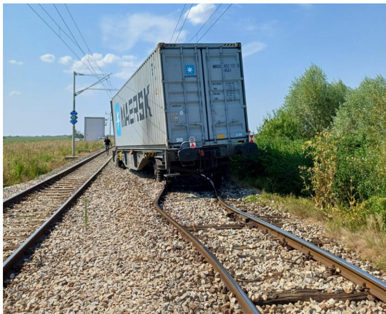
Slika 3. Prikaz iskliznuća vagona između kolodvora Šid i Tovarnik 1, izvor: anonimnan
