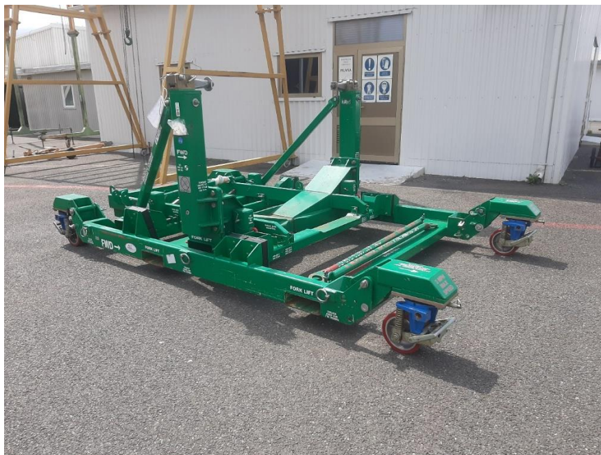
Slika 13. Postolje za transport motora zrakoplova Airbus A220
