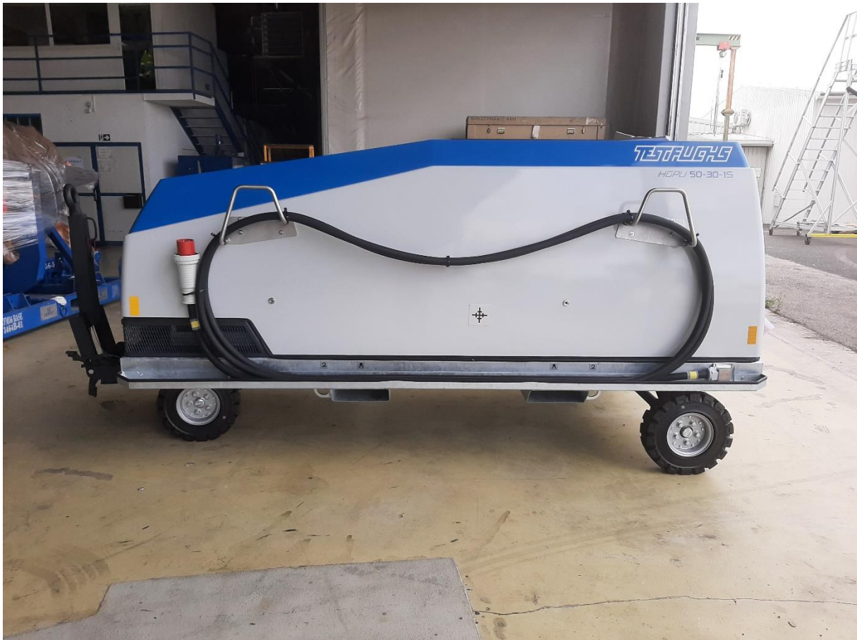
Slika 14. Vanjska hidraulična jedinica za zrakoplov Airbus A220
