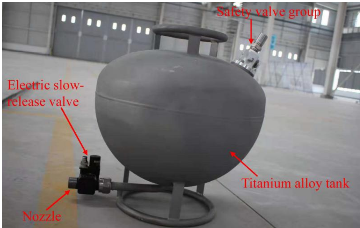
Slika 14. Oprema za gašenje požara sustava LY100
