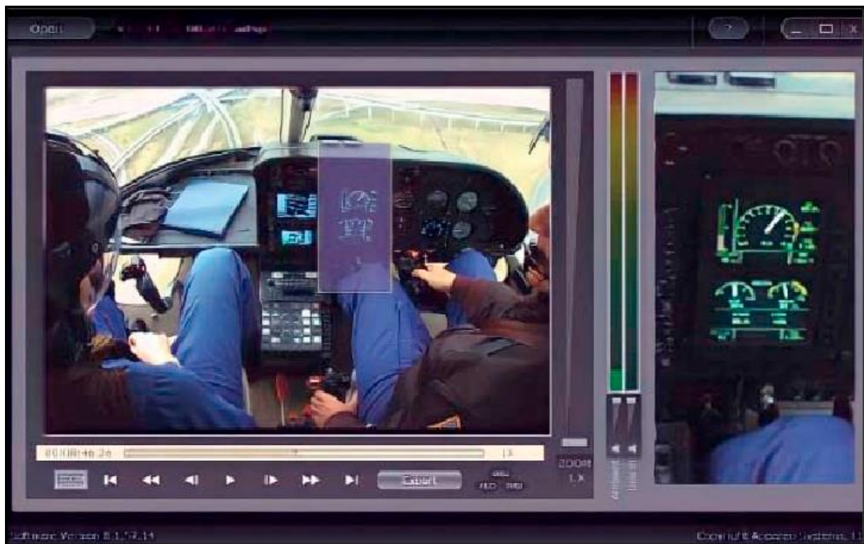
Slika 19. Snimač slike kokpita Izvor: [30]
