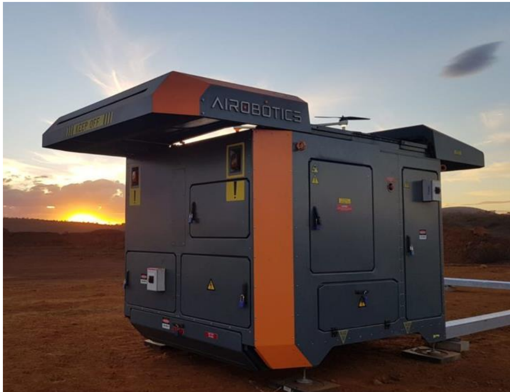
Slika 49. Zemaljska stanica Airobotics
