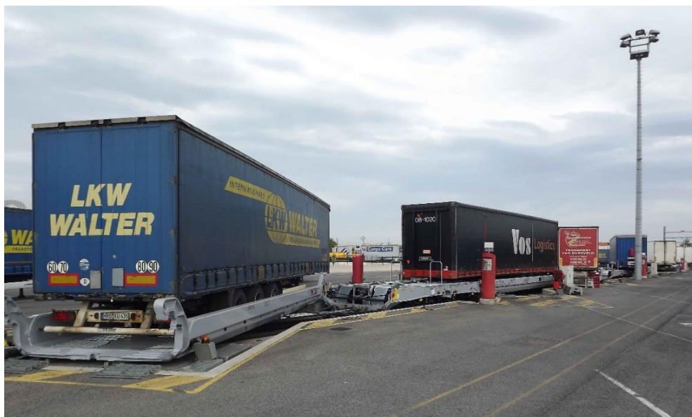
Slika 5 Niskopodni transportni vagon prilikom poravnanja sa smjerom željeznice, [24]
