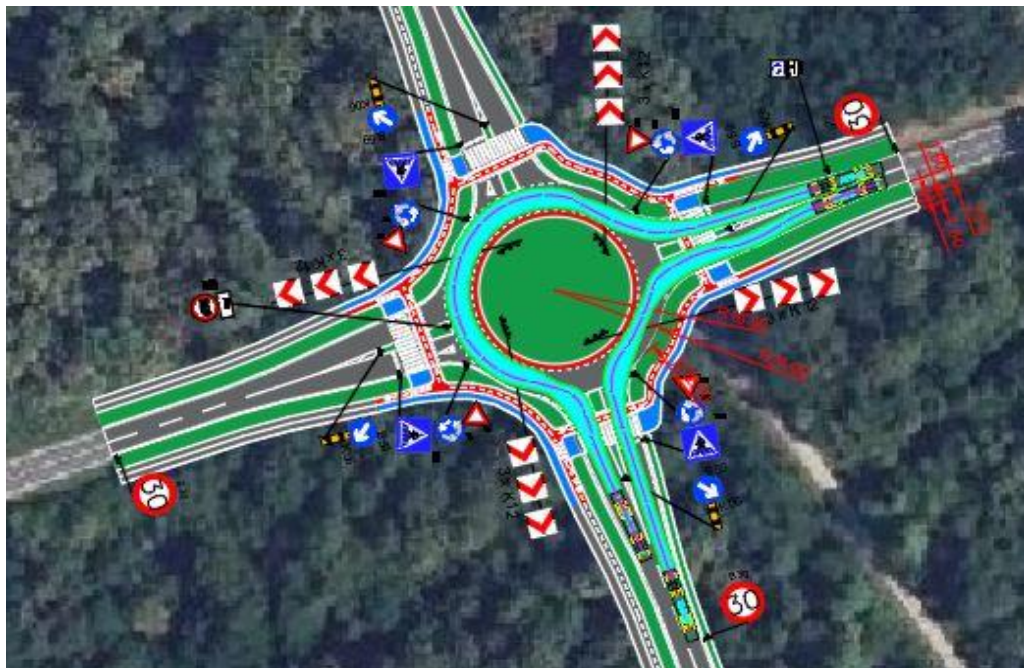
Slika 26. Provjera provoznosti kružnog raskrižja
