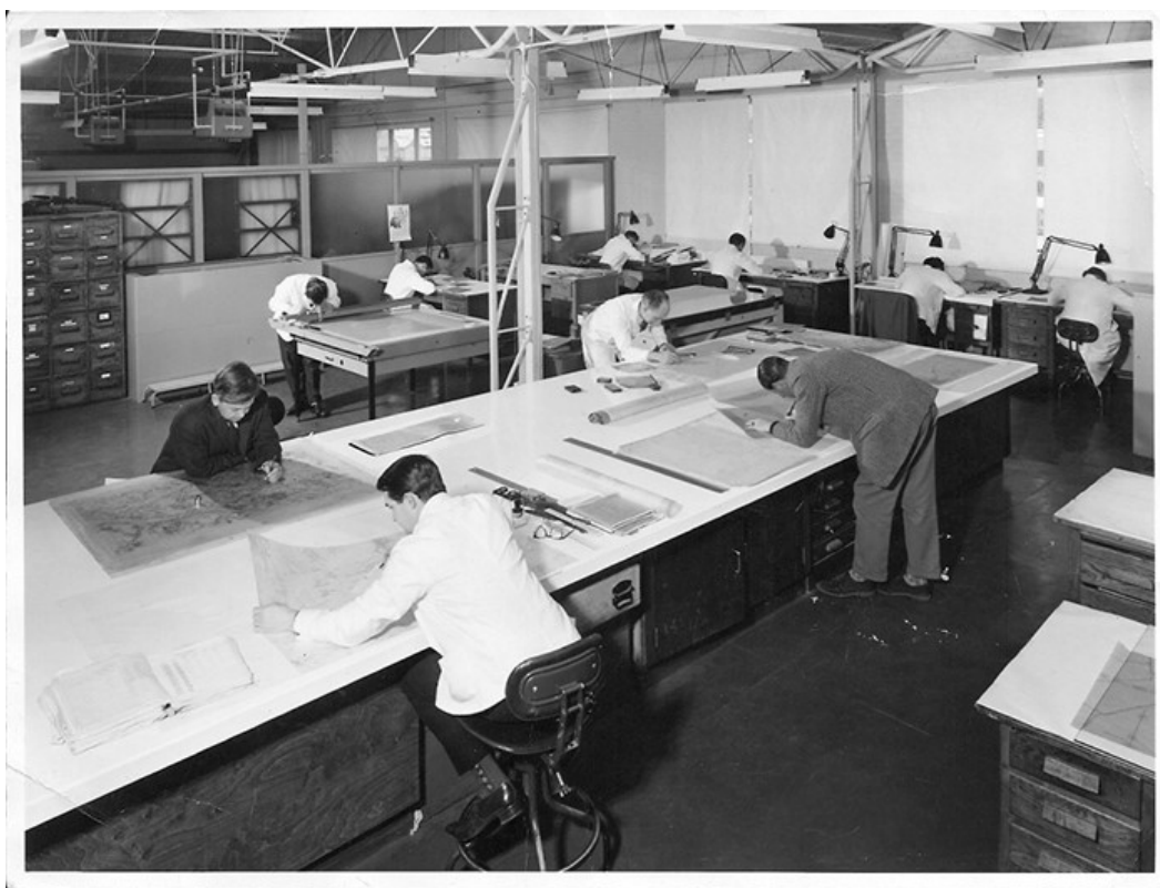
Slika 5. Izrada slojeva karata na plastičnim folijama
