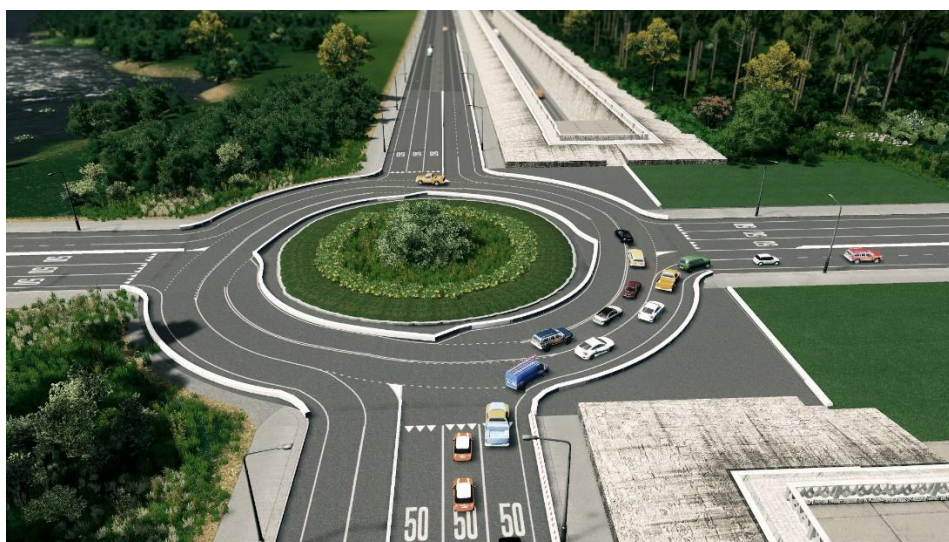
Slika 6. Prijedlog kružnog raskrižja za smirivanje prometa u gradovima, [14]
