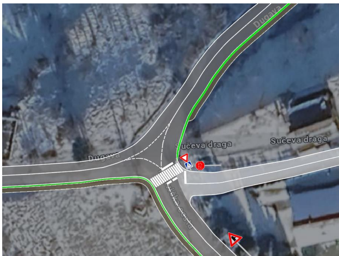
Slika 64. Predloženo rješenje na raskrižju Ulica Dugava - Ulica Sučeva draga - Molvička cesta [Izvor: izradio autor]
