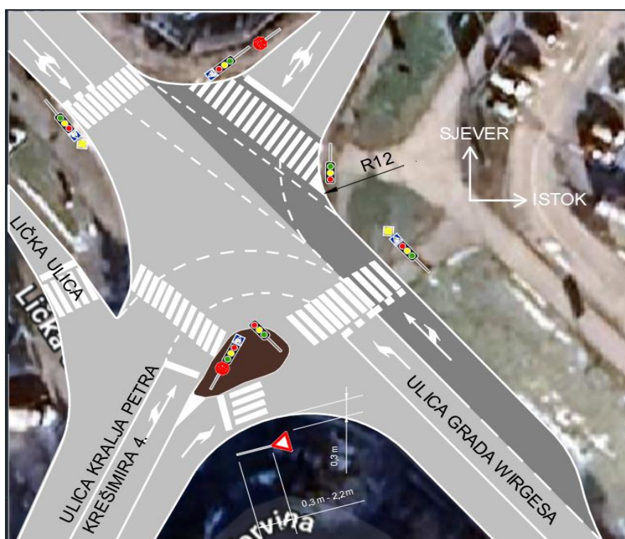
Slika 48. Predloženo rješenje na raskrižju Ulica grada Wirgesa - Ulica kralja Petra Krešimira 4. [Izvor: izradio autor]
