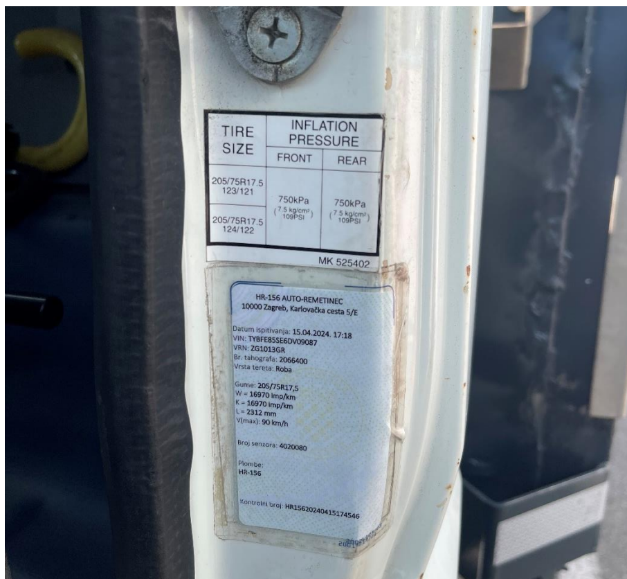
Slika 18. Identifikacijska naljepnica tahografa na vozilu N2 kategorije vozila
