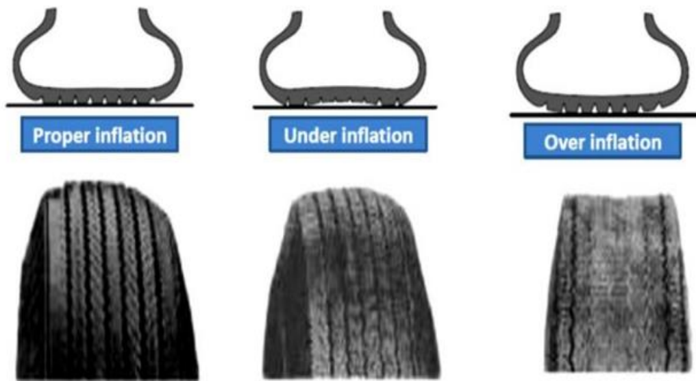
Slika 7. Utjecaj optimalnog, preniskog i previsokog tlaka u pneumatiku
