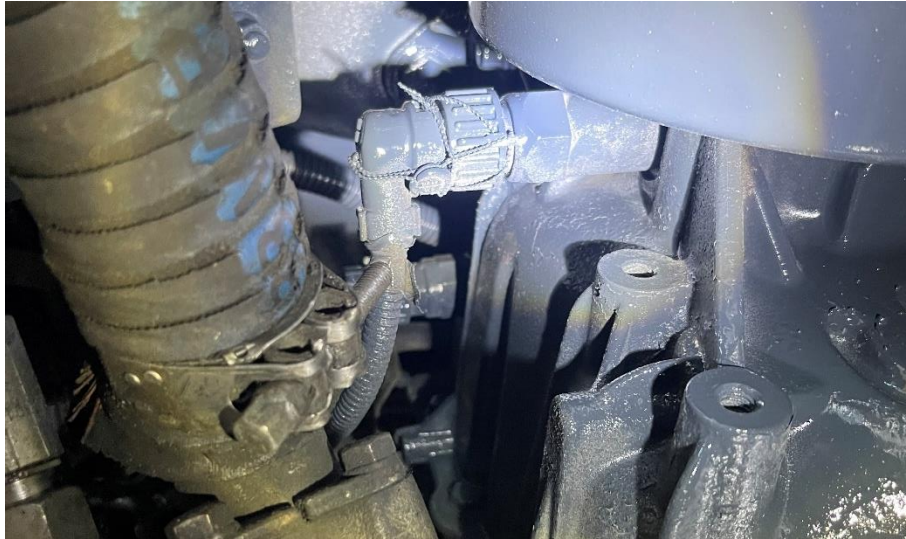
Slika 17. Prikaz plombe tahografa na senzoru mjenjača vozila N2 kategorije vozila
