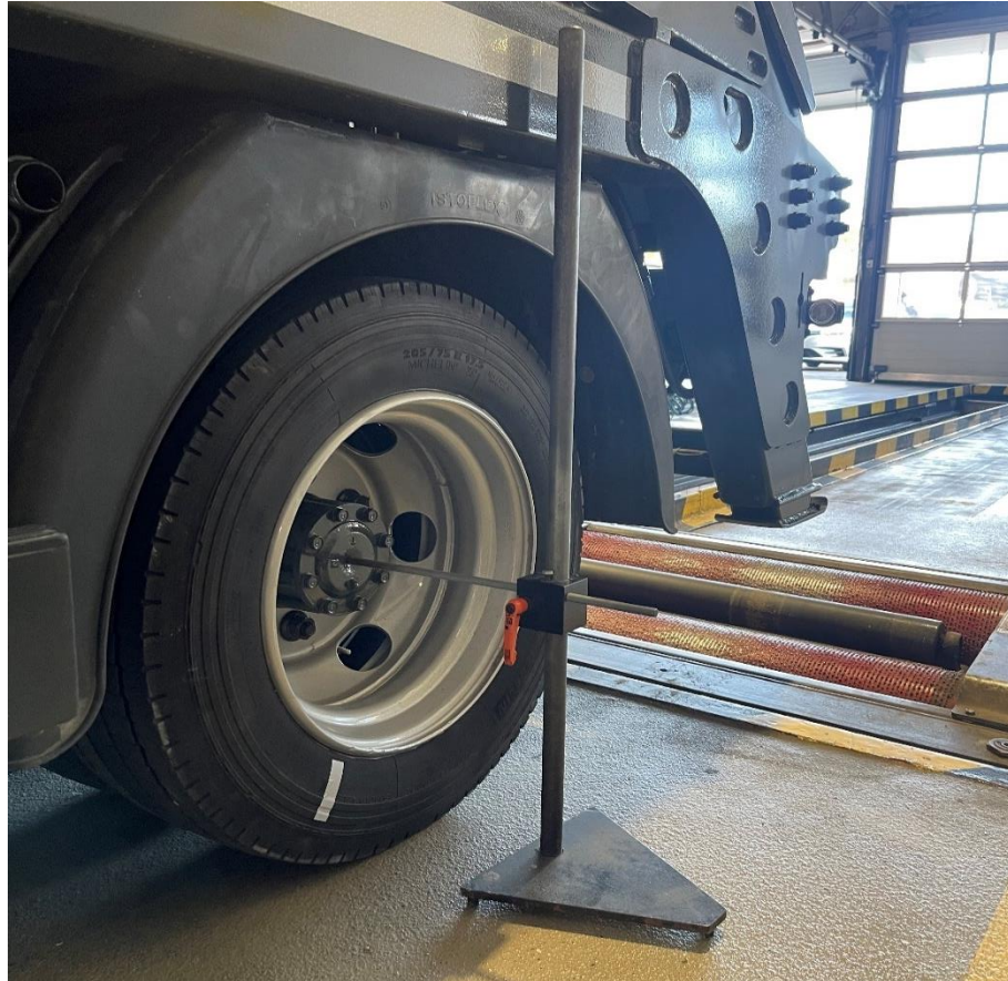
Slika 10. Prikaz mjerenja radijusa pneumatika pomoću stalka
