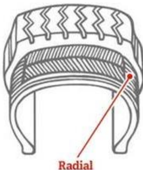
Slika 22: Prikaz radijalnog pneumatika
