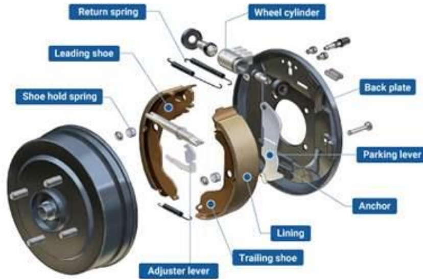
Slika 5: Bubanj kočnica u dijelovima
