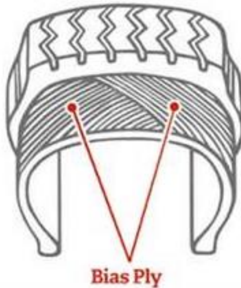
Slika 24: Prikaz dijagonalnog pneumatika
