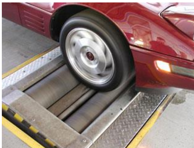
Slika 40: Uređaj za ispitivanje sile kočenja vozila
