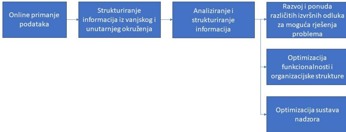
Slika 5. Funkcije digitalnog sustava upravljanja kvalitetom
