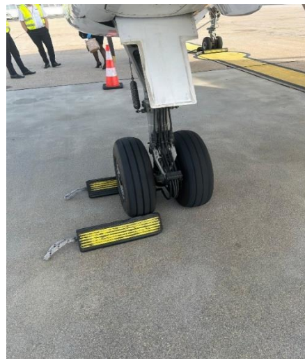
Slika 10. Prikaz ispravno postavljenih podmetača i čunjeva
