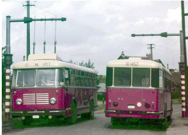
Slika 2. Prvi autobus na hibridni pogon pod nazivom "Gyrobus"
